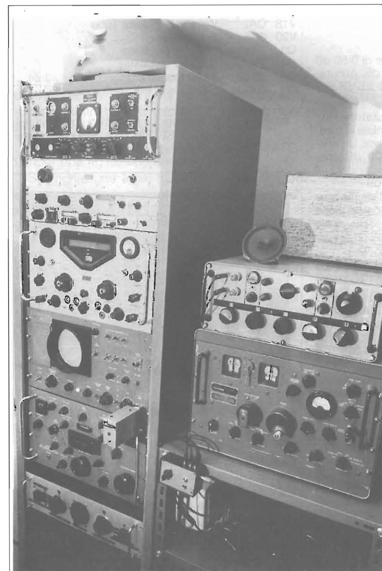
Vista del Panalyzer SB-12b insieme agli altri apparati della mia stazione, in particolare sotto ad esso il COLLINS 390A/URR alla cui uscita IF viene connesso. Lo scatolotto applicato all'ingresso VFO INPUT J104 sul pannello frontale è un generatore quarzato a 955 kHz, indispensabile per centrare il segnale IF con scansioni di ampiezza ridotta.
